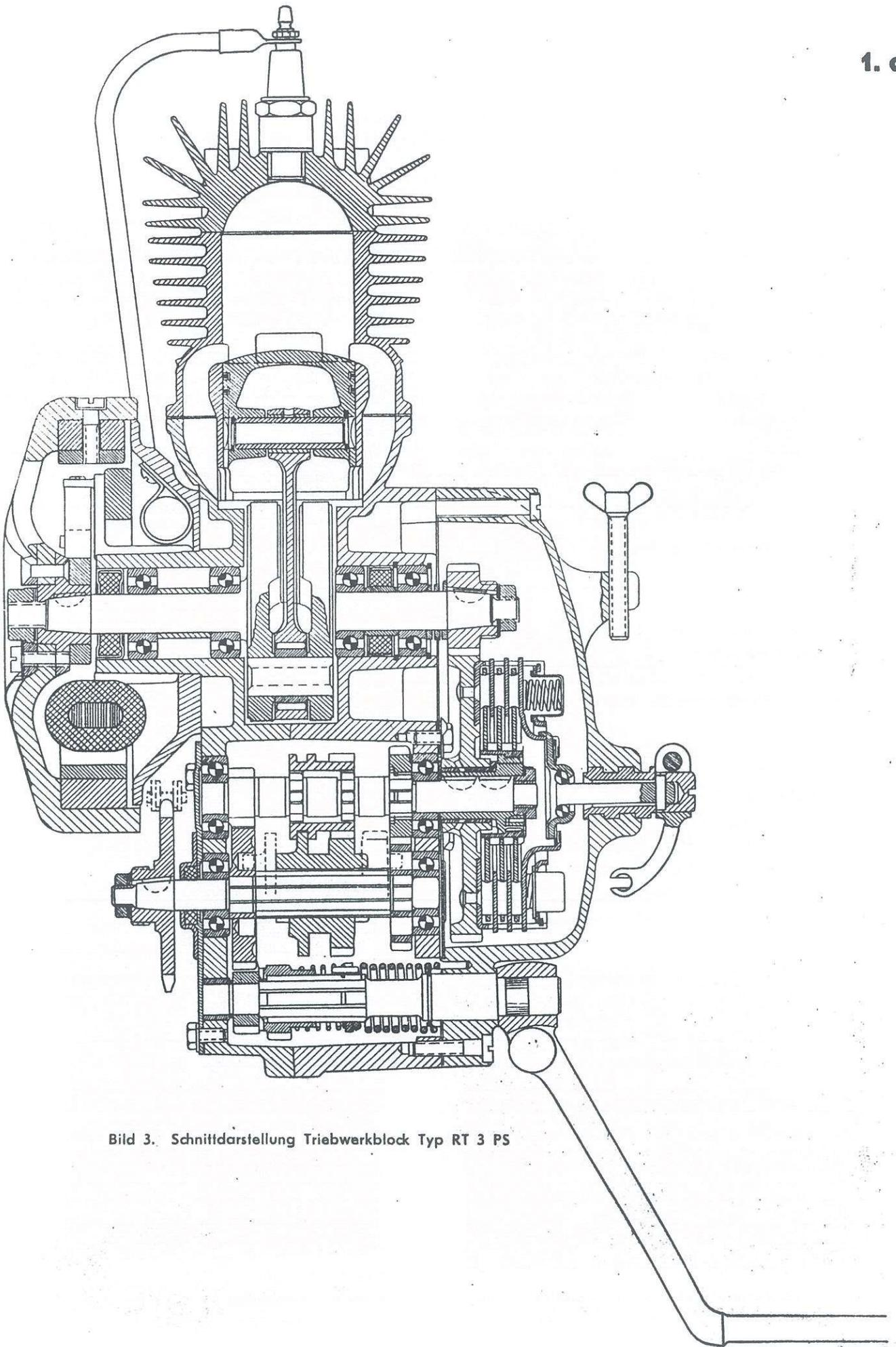
Bild 3. Schnittdarstellung Triebwerkblock Typ RT 3 PS
