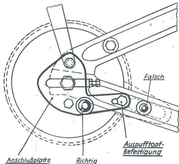
Bild 254. Hinterer Anschluß bei SB 500 nur unter Verwendung der Anschlußplatte Ersatzteil-Nr. 19154 zulässig
