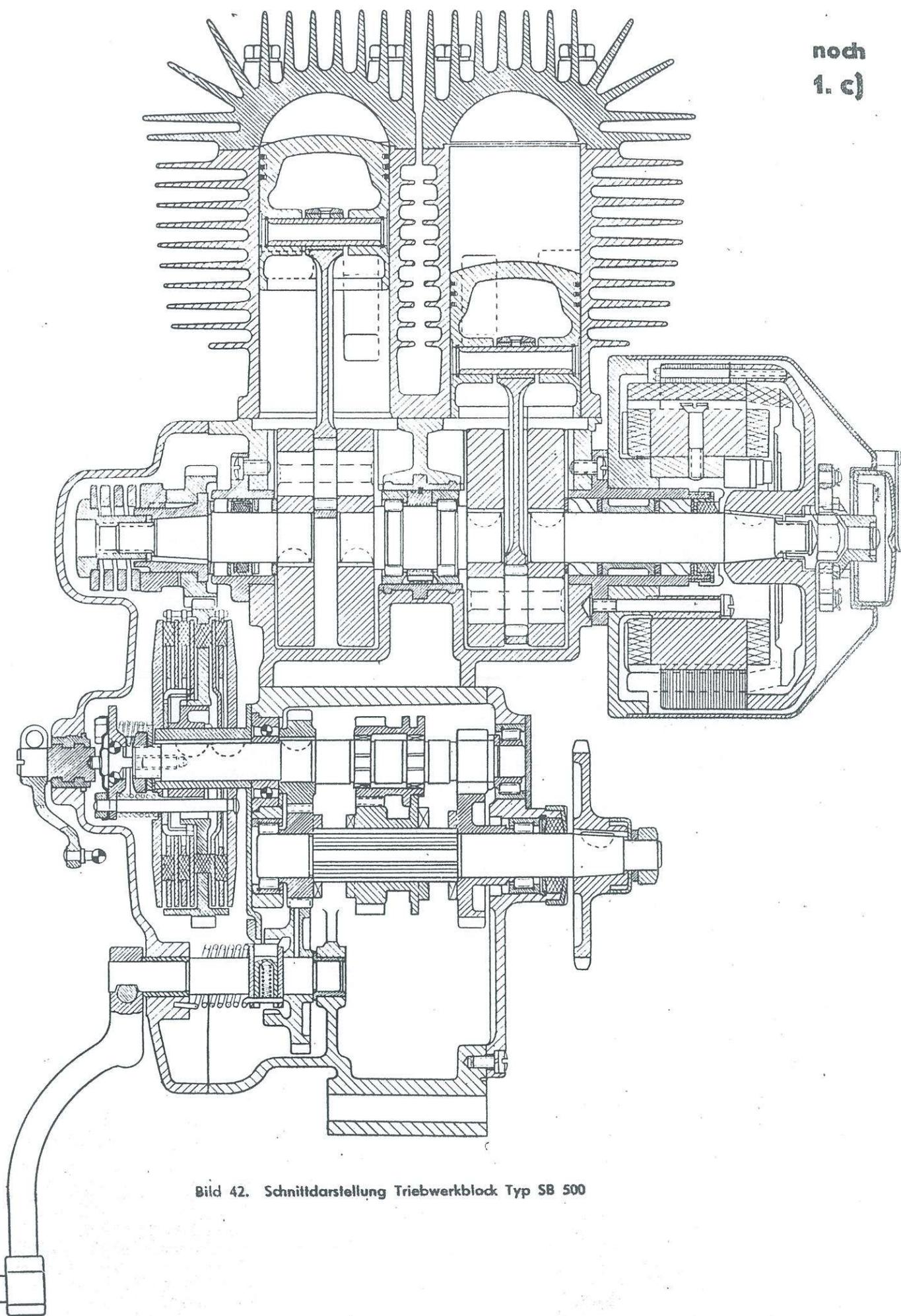
Bild 42. Schnittdarstellung Triebwerkblock Typ SB 500
