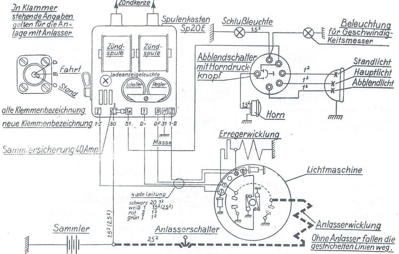
Bild 250. Schaltbild SB 500 mit Spulenkasten Sp 20 E
