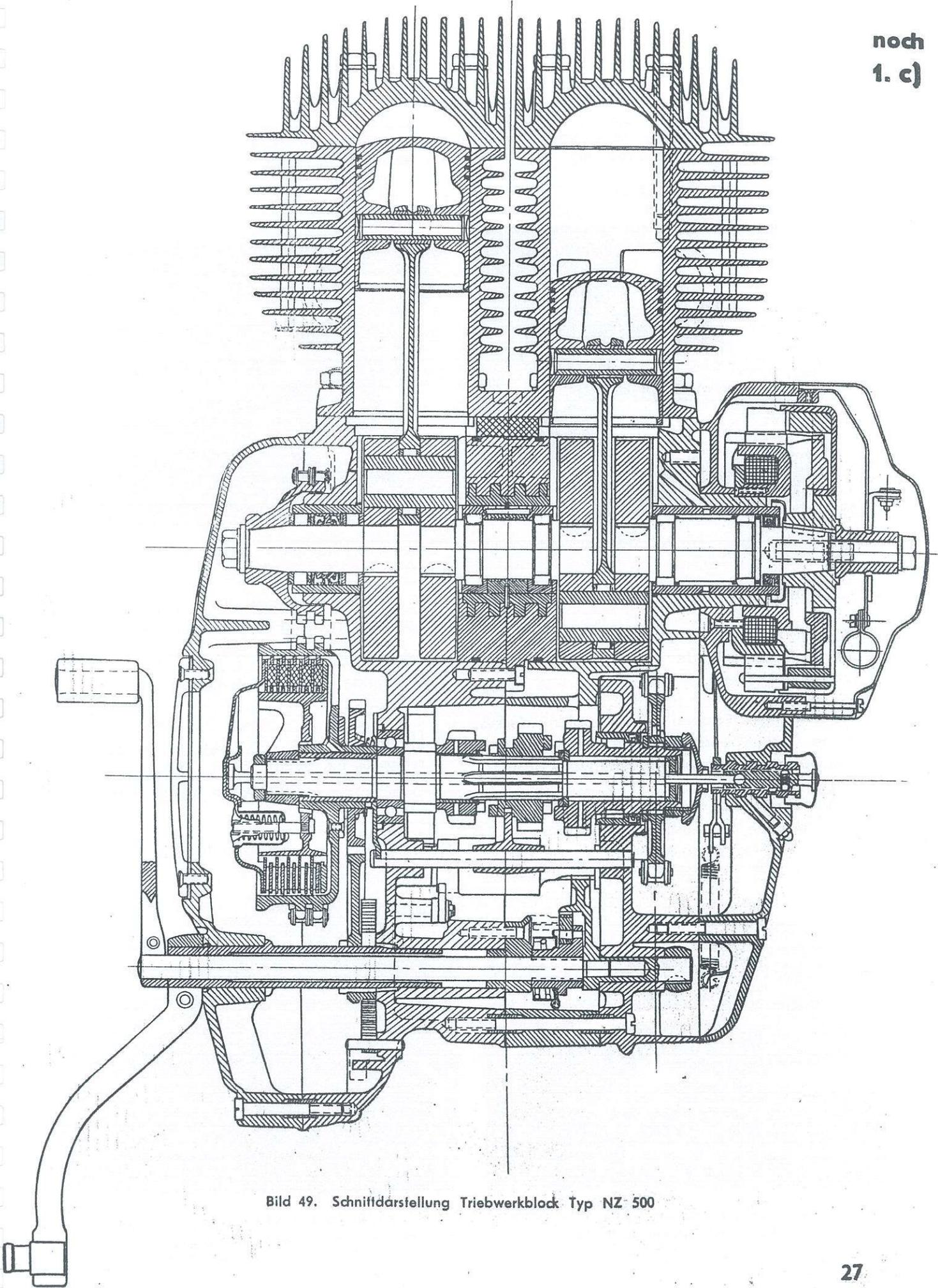
Bild 49. Schnittdarstellung Triebwerkblock Typ NZ 500
