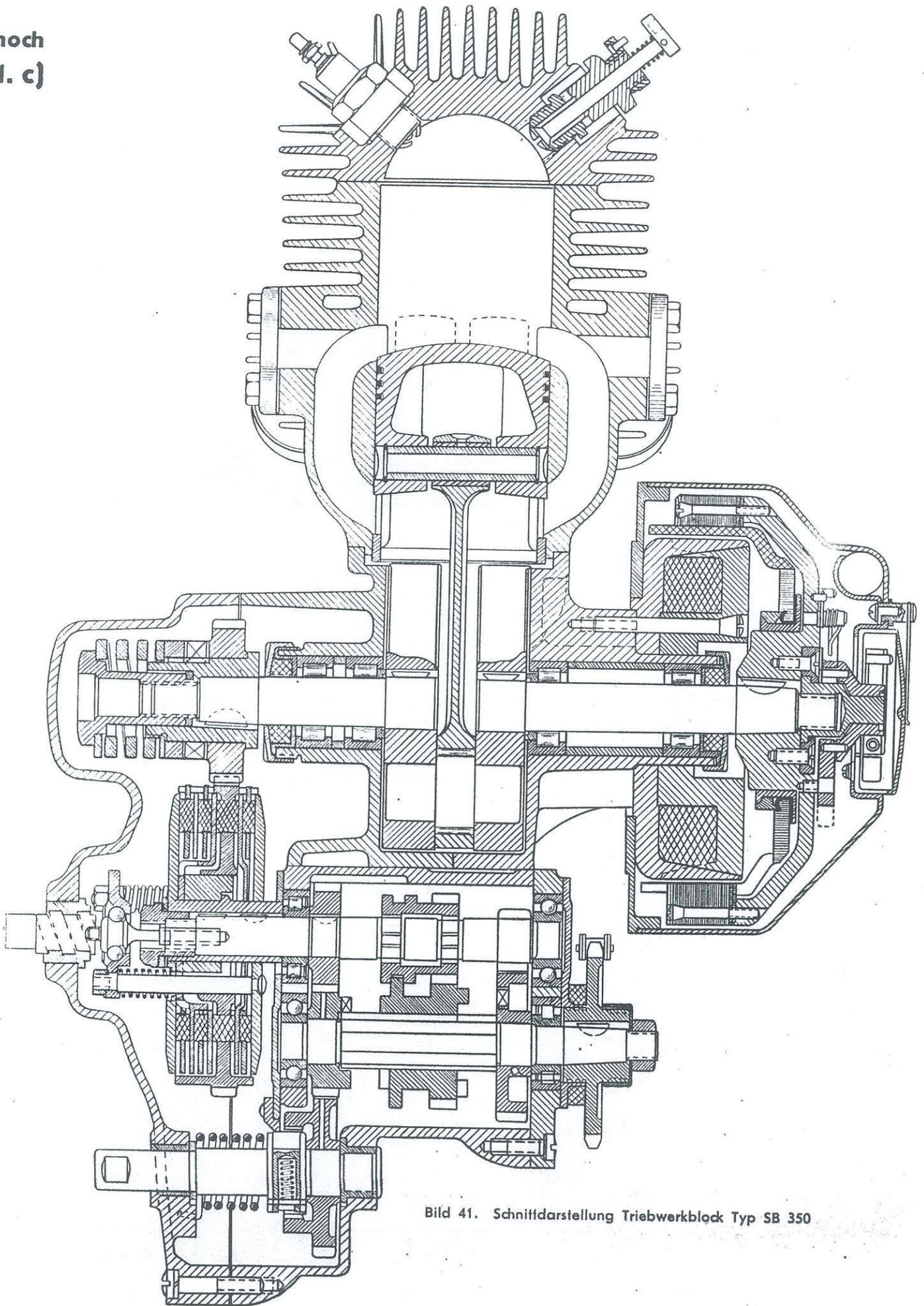
Bild 41. Schnittdarstellung Triebwerkblock Typ SB 350
