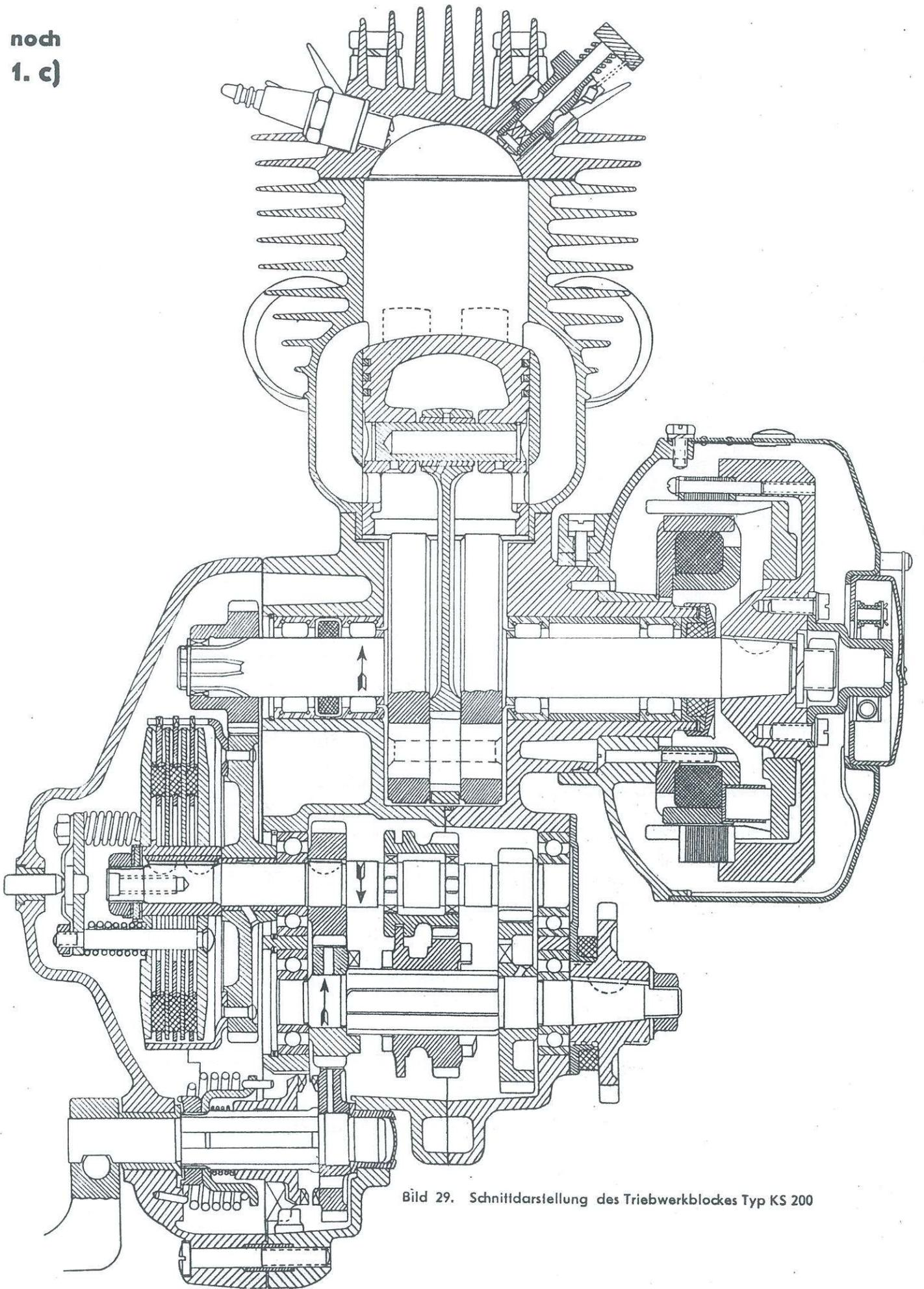
Bild 29. Schnittdarstellung des Triebwerkblockes Typ KS 200
