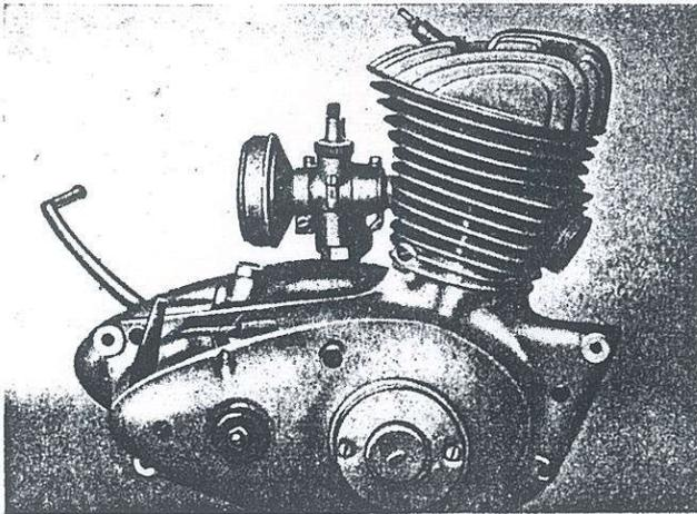
Bild 16. Triebwerkblock Typ RT 125, Lichtmaschinen Seite
