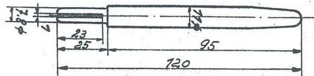
Bild 86. Maßskizze des Einführdornes für Kolbenbolzen bei RT-Modellen
