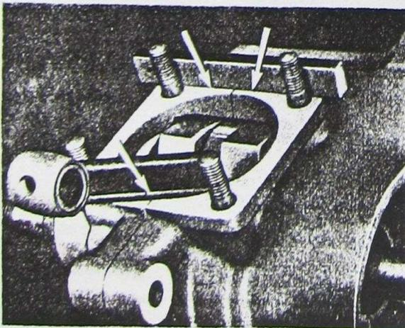
Bild 104. Der Pleuelschaft bzw. die Kurbelwelle müssen symmetrisch zur Gehäusetrennfuge liegen (unterer Pfeil). Die Flanschflächen beider Gehäusehälften dürfen nicht gegeneinander versetzt sein; prüfen mit Lineal (obere Pfeile)
