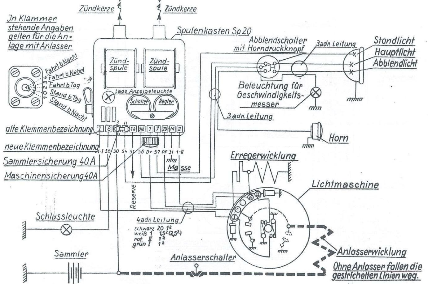
Bild 251. Schaltbild SB 500 mit Spulenkasten Sp 20
