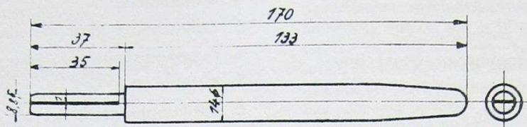
Bild 99. Maßskizze des Einführdornes für Kolbenbolzen bei KS-, SB- und NZ-Modellen
